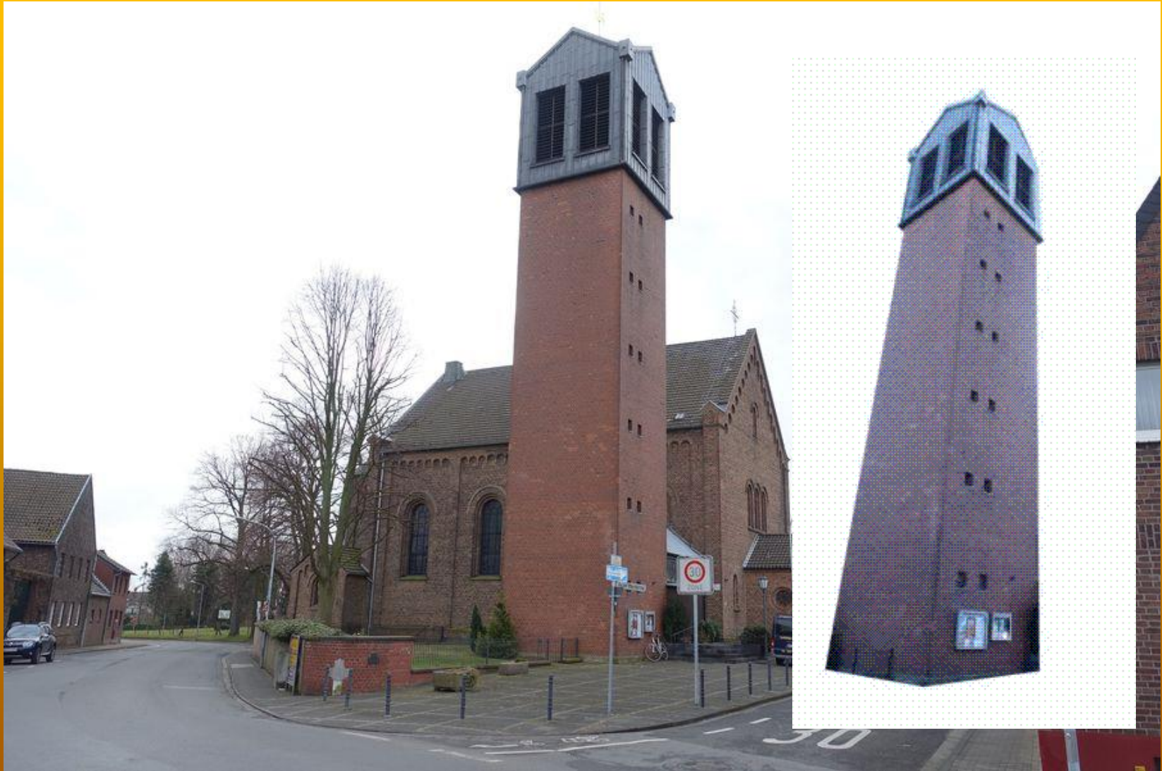
Ein freistehender Glockenturm: Er schwingt, bei Wind und Glockenschlag!
