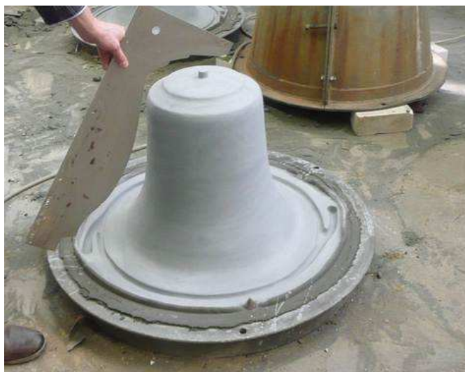
Vorbereiter Glockenkern und Schablone für den Glockenmantel. Fa. Eijbsbouts, Asten, Niederlande.
