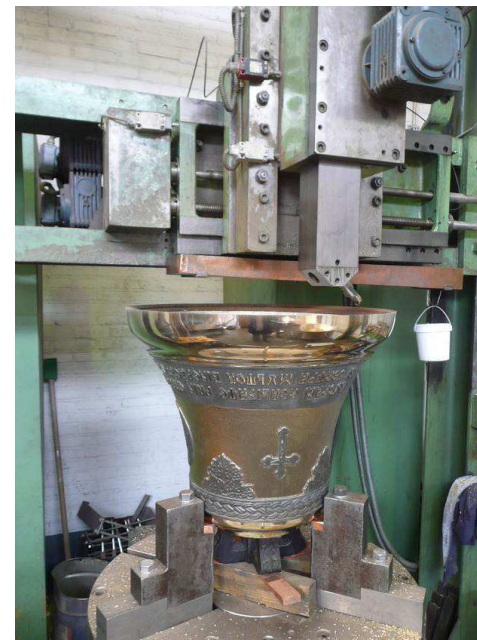
In einer riesigen Drehbank der Glockengießerei Eijsbouts in Asten (NL) werden Glocken nachgestimmt.
