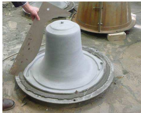
Vorbereiter Glockenkern und Schablone für den Glockenmantel. Fa. Eijsbouts, Asten, Niederlande.
