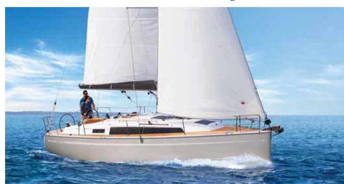
Ein großes Cockpit, von dem aus der Skipper bequem alle Fallen und Schoten erreichen kann, und Rollsegel zeichnen eine gute Yacht für Einsteiger aus
